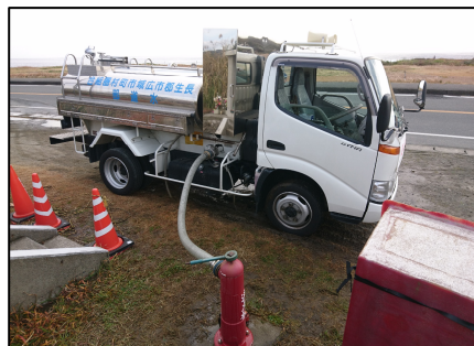
<消火栓からの補水>
